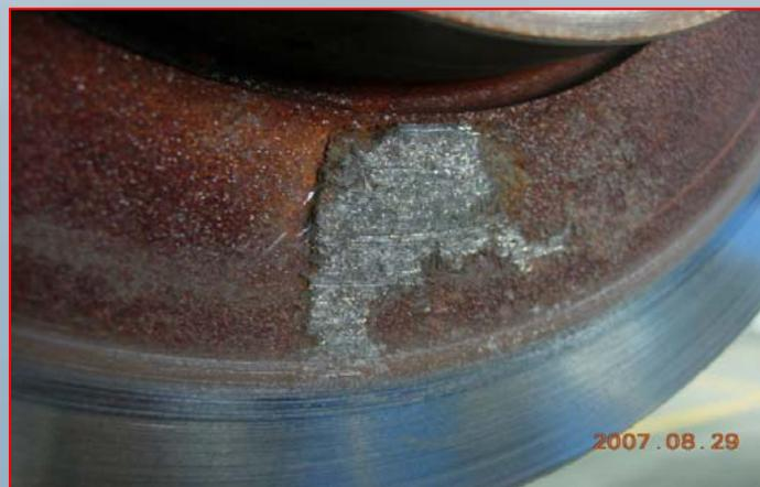
制动盘严重侵蚀和发生粘结
